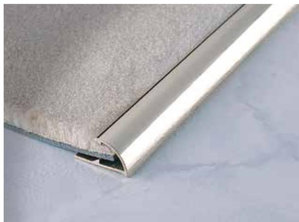
Terminali per pavimenti flessibili come moquette e fibra di cocco. I profili, pressandoli, si chiudono imprigionando il rivestimento in modo duraturo coprendone i difetti di taglio e preservandone il bordo.
